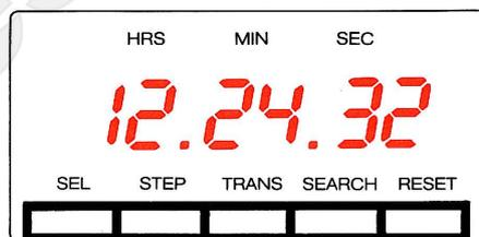
Während dem Positionieren kann durch Drücken der Tasten PLAY [20] der Wiedergabebetrieb vorgewählt werden. Zur Signalisation blinkt die gelbe LED oberhalb der Taste A-LOC [14]. Beim Erreichen der Bandposition 12.24.35 wird automatisch auf Wiedergabe geschaltet.
