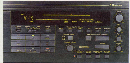
Komfortable Aussteuerungsanzeige: Sie hat 2x24 Segmente. Sobald man am Azimut-Knopf dreht, wird sie zur Positionsskala für die Spaltneigung
