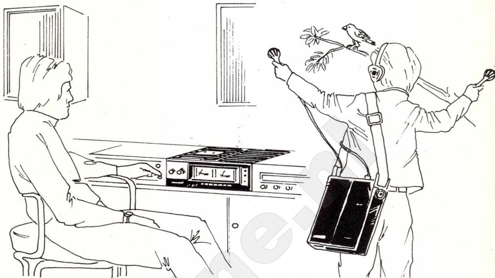
Le NAKAMICHI, en extérieur, est autonome : il fonctionne sur piles ou sur batterie de voiture. A la maison, il est alimenté sur secteur par son bloc-transformateur. Comme les NAKAMICHI 1000 et 700, le 550 comporte deux crête-mètres avec une échelle de lecture jusqu'à 40 dB ; ce qui correspond aux possibilités de la dynamique d'enregistrement du 550. Ces lectures sont particulièrement utiles pour les enregistrements directs en extérieur.
