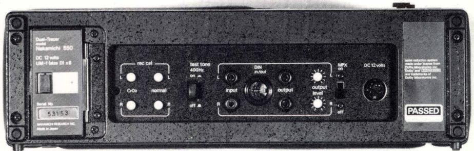
Panneau arrière présentant les diverses entrées et sorties, la commande de l'oscillateur 400 Hz, les pré-réglages des niveaux, etc.
